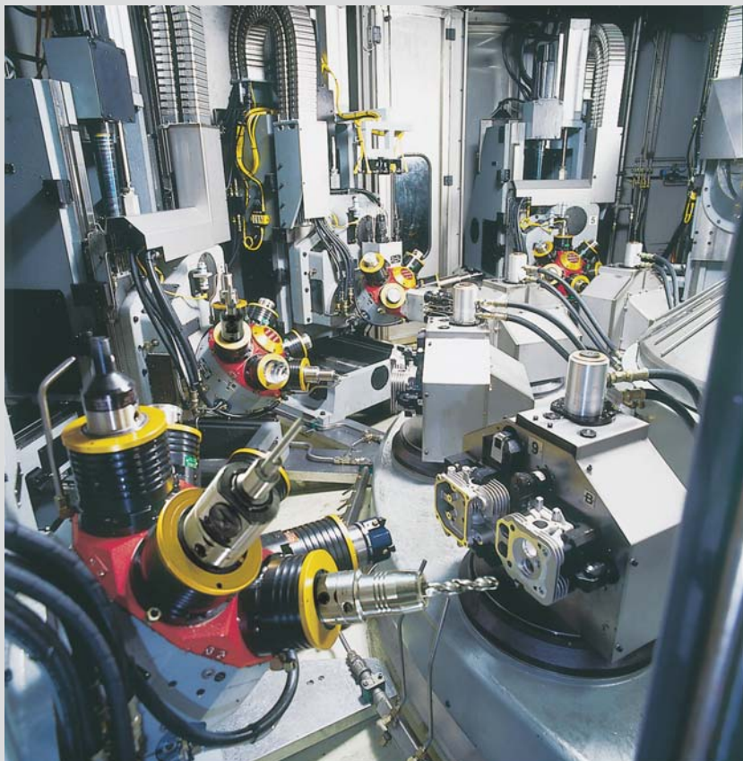
Tourelles revolver sur machine transfert Revolverkopf auf Transfermaschine Revolver head on transfer machine
