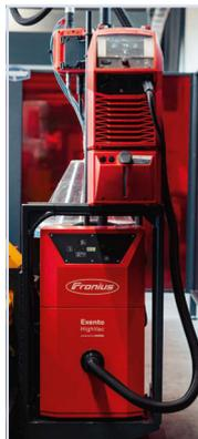
**Mitfahrende Hochvakuum-Absauganlage in Kombination mit leistungsstarkem Absaugschweißbrenner**
