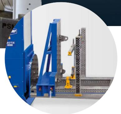
Wer in großen Dimensionen denkt, braucht Equipment, das viele Möglichkeiten bietet. Mit dem Manipulator Robotix IP positionieren Sie flexibel, fertigen effizient, und arbeiten ergonomisch. In entspannter Haltung lässt sich eine Schweißnaht wesentlich exakter ziehen. Zudem ermöglicht die optimale Positionierung des Werkstücks, einen idealen Fertigungsprozess: kein Fließen des Schweißgutes. Aus einer Vielzahl von Lösungen können wir Ihnen das passende Produkt anbieten.
