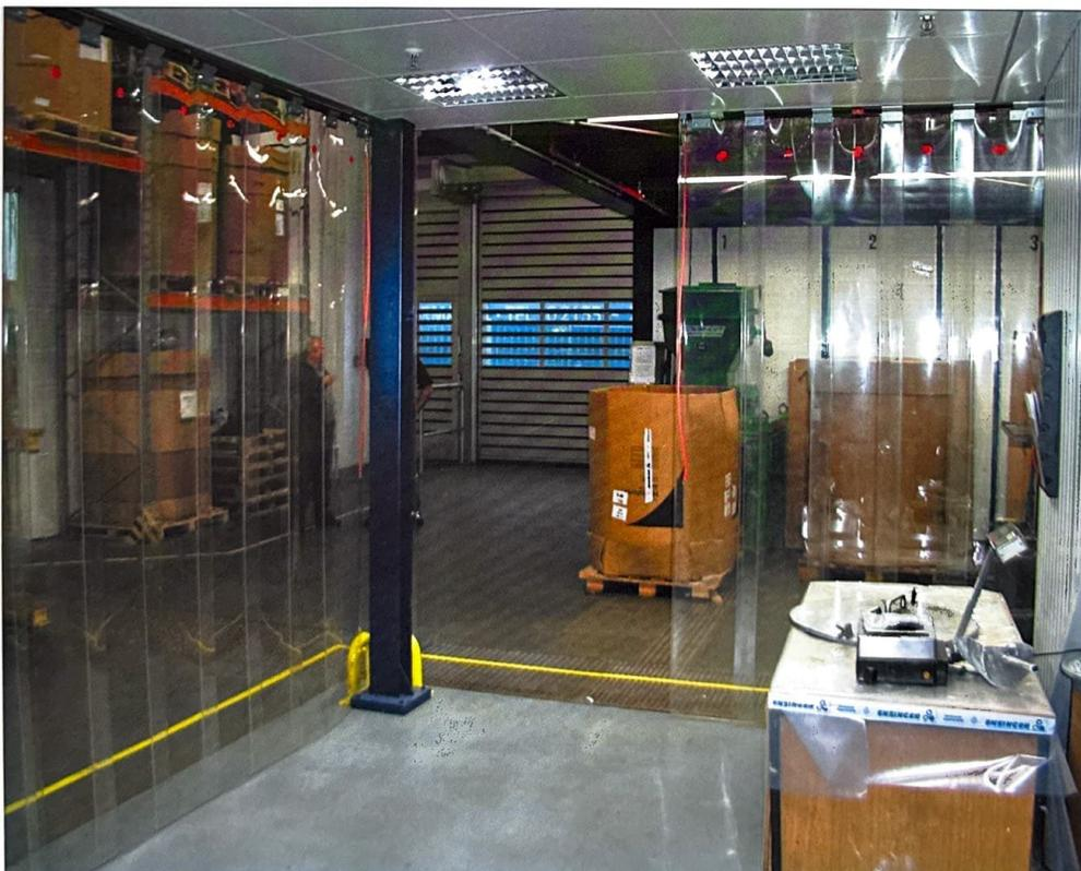
Auch bei geöffnetem Rolltor bleibt der abgeteilter Bereich vor Zugluft, Kälte, Staub und Lärm geschützt - mit integriertem Schiebelement kann der Raum geöffnet werden.
