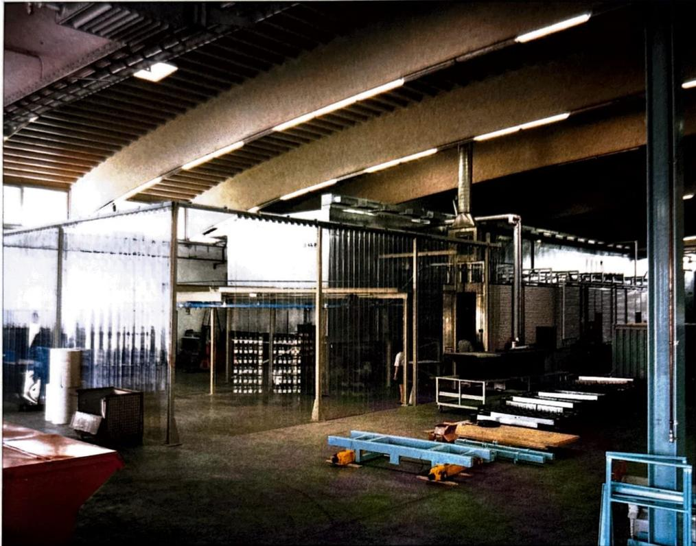
clear-flex Lamellen-Raumteiler zur Trennung von Lackieranlagenbereich und Montagebereich – Schutz gegen Zugluft und Staub
